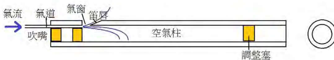
圖 3 膠管笛的主要構造
