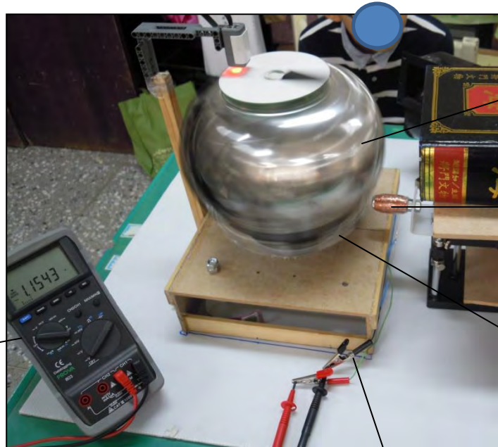
鱷魚夾，夾住三用電表測量電壓與電流。
