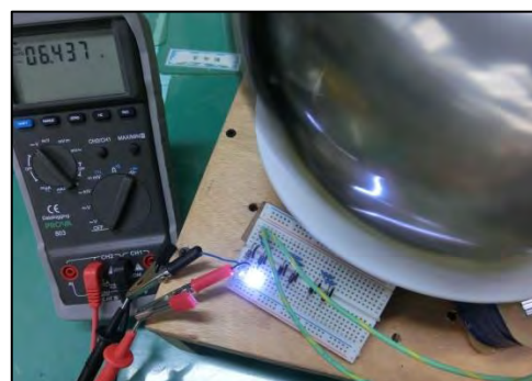
接上 4.5VLED 的直流電壓。
