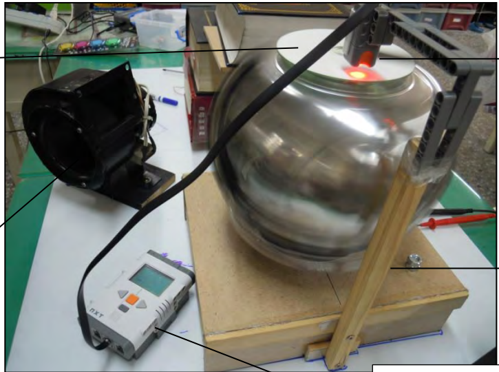
程式計數器，先寫好程式，可記錄經過光電感應器的轉動圈數。
