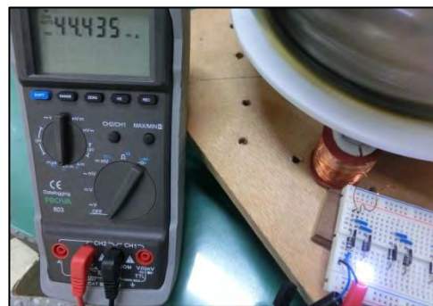
接上 4.5VLED 的直流低電流。
