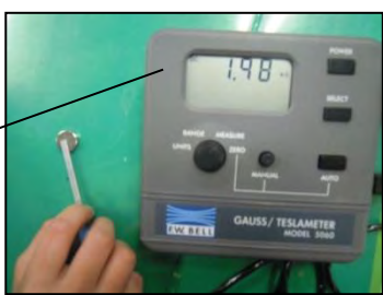
高斯計，測量磁鐵的強度。
