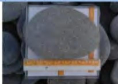
石頭較大，粗略估計 a 軸至少約 30cm 以上，礫石測量器之測量平台需增大。
