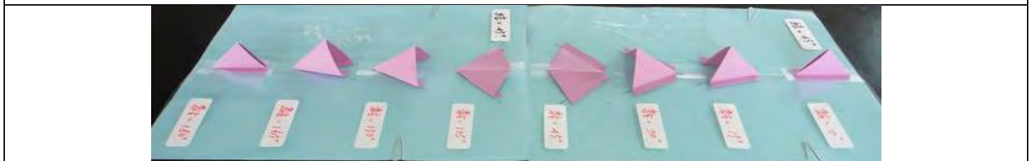
圖 5-2-3：結構角 =45^\circ ，但黏貼角 0^\circ, 15^\circ, 30^\circ, 45^\circ, 135^\circ, 150^\circ, 165^\circ, 180^\circ 八種。
