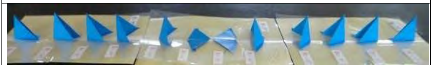
圖 5-2-5：結構角 =75^\circ ，但黏貼角 0^\circ, 15^\circ, 30^\circ, 45^\circ, 60^\circ, 75^\circ, 115^\circ, 120^\circ, 135^\circ, 150^\circ, 165^\circ, 180^\circ 十二種。
