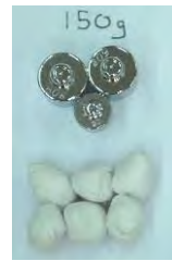
圖 8：150g 的重物，可以用 6 團 5g 的黏土球、2 個 50g 砝碼、1 個 20g 砝碼，組合出重物團
