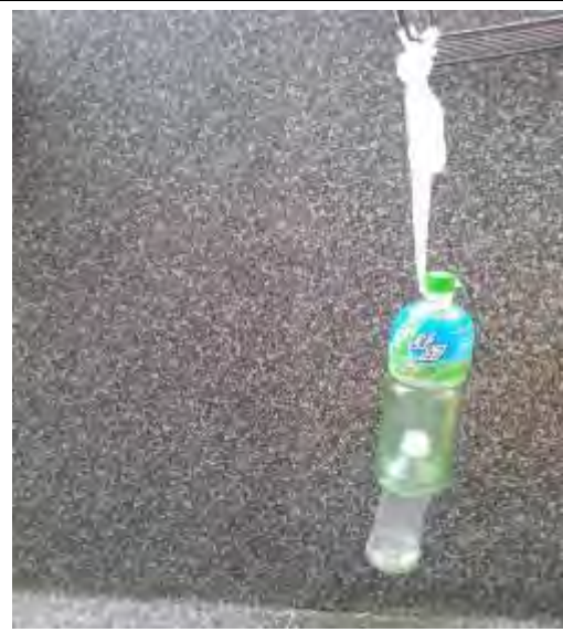
圖 31 此次實驗從 102 年 5 月 3 日到 102 年 5 月 9 日，天氣型態多雲至陰天，此為 10 號捕蠅器，以大寶特瓶在上小寶特瓶在下製作二層式，誘餌放置在小寶特瓶底部，在小寶特瓶底部約 4 公分處打一個洞以誘蠅類進入，此實驗在觀察蠅類在密閉空間中是否向上飛。結果在大寶特瓶底部捕獲 6 隻蠅類。後來小寶特瓶底部生蛆。
