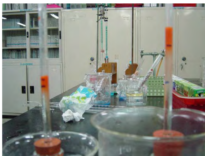
汽水中二氧化碳在不同溫度水中推高水柱
