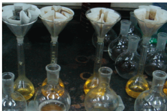
圖十八 過濾方法取上澄液分析
