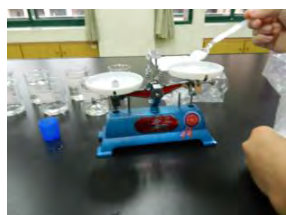
實驗 8：不同濃度（2%、4%）的硼砂水混合保力龍膠，對於水黏土軟硬度的影響。
