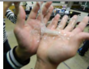
實驗 7：不同濃度（2%、4%）的硼砂水混合膠水，對於水黏土軟硬度的影響。
