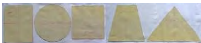
圖二 重量相同但形狀不同的各式塑膠板扇片
