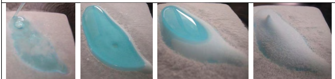
烙印乾冰後，取出台灣鋁片倒入藍色 5%硫酸銅溶液結冰觀察↑
