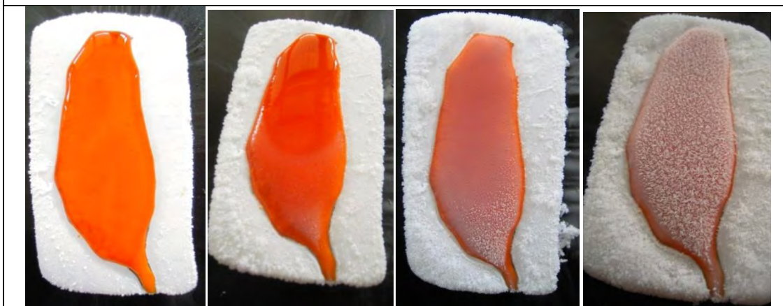
乾冰內墊鋁片的 5%橘色糖水溶液結冰情形 ↑
