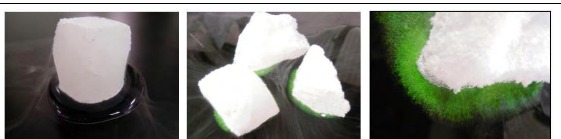
乾冰使色素水結冰的實驗照片
