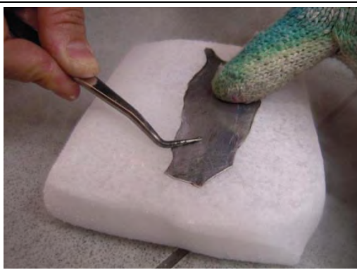
將鋁片剪製台灣形狀，以蠟火加熱後烙印在乾冰塊上
