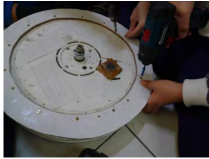
強力磁鐵固定飛輪上
