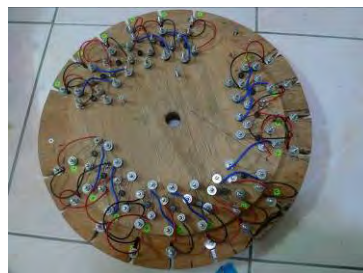
發電盤正面配線
