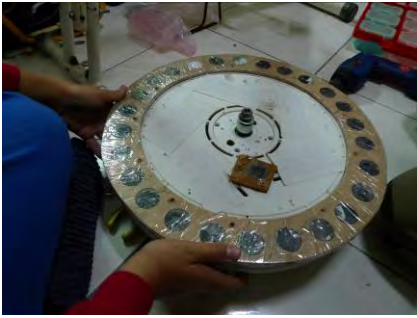
磁鐵環固定在飛輪上
