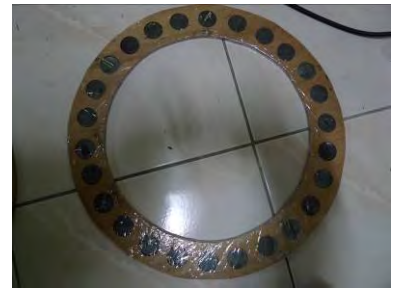
將磁鐵用膠帶固定在木環上
