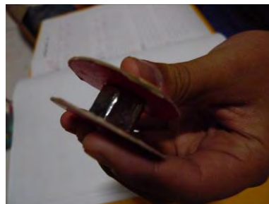
完成的線圈槽
