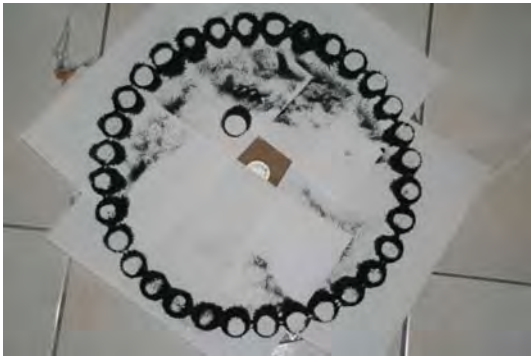
利用鐵砂所形成的磁力圈
