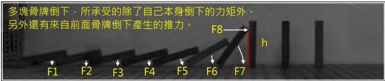
發現：骨牌豎著時，重心較高，倒下時重心下降，倒下的過程中，其重力位能會轉化為動能，倒在第二塊骨牌上，這個動能就轉移到第二塊骨牌上，第二塊骨牌會將第一塊骨牌轉移來的動能和自已倒下過程中由本身具有的重力位能轉化來的動能之和，再傳到第三塊骨牌上.....，所以每塊骨牌倒下時，具有的動能都比前一塊骨牌大。
