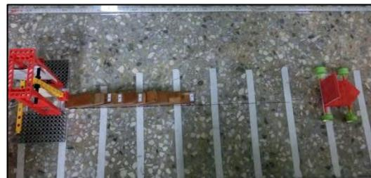
推論：間距 5cm 時因為骨牌轉動角度大，撞擊高度也高，一開始產生的力量就較大，到第十塊時推動的距離都是最遠的。而間距 1cm 只有兩、三塊時，轉動角度小產生的力量較小，直到四塊以後骨牌倒下時堆疊在一起的力量會瞬間變大，因此一下子車子就會被推得較遠。
