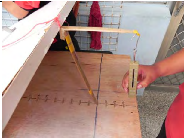
A 竹片撐住 B 竹片的竹節，木板壓住 B 竹片的竹節上端
