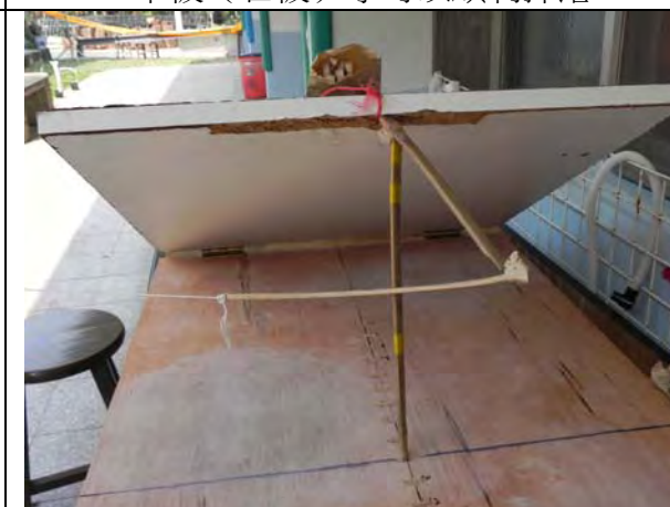
A 竹片插在木板外緣的外面， 木板（石板）才可以順利掉落
