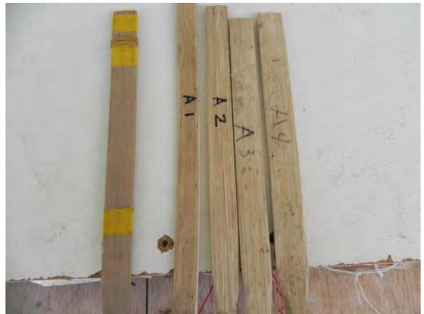
A 竹片的竹膜面比較粗糙
