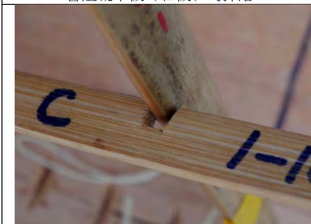
A 竹片插在木板外緣的正下方， 會阻礙木板（石板）的掉落
