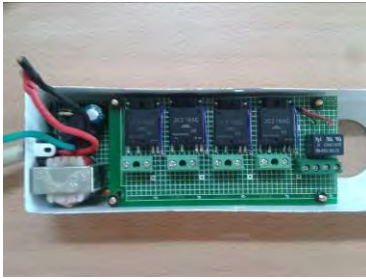
電路板裝置在延長線內
