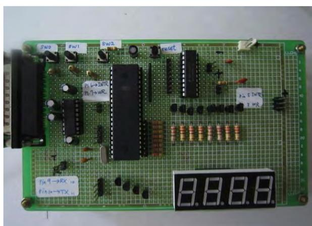
訊號處理暨顯示介面：當中使用 ADC 並經 89S51 處理訊息，再透過 RS-232 傳送至 PC 端，另有提供 4 位元 7 段顯示器，作為與**電腦顯示的波形作對照**之用。
