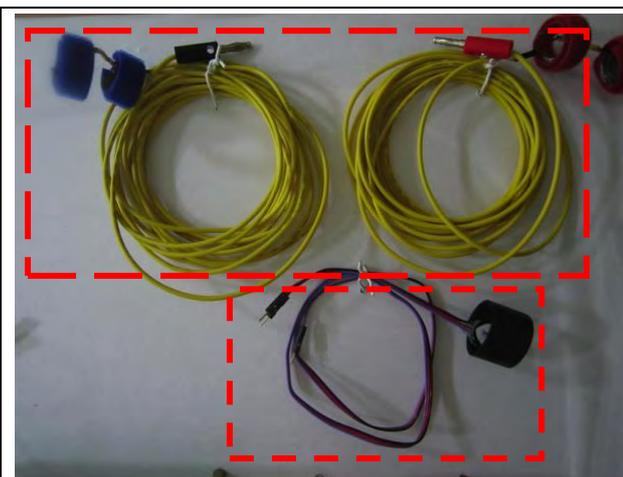
訊號輸入部分：又可分為兩個部分，第一部分如左圖紅色框中偵測手指皮膚電阻的指套傳輸線，套在**食指**跟**無名指**，第二部分如左圖藍色框中量測血氧濃度的指套傳輸線，套在**中指**。
