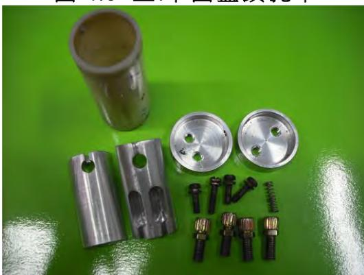
圖 4.10 煞車分配器零件圖
