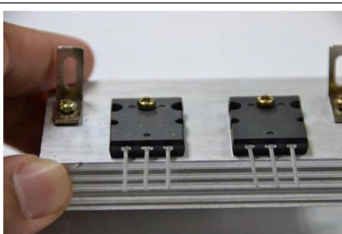
電晶體固定在散熱片上，使電晶體不會因過熱而燒燬。
