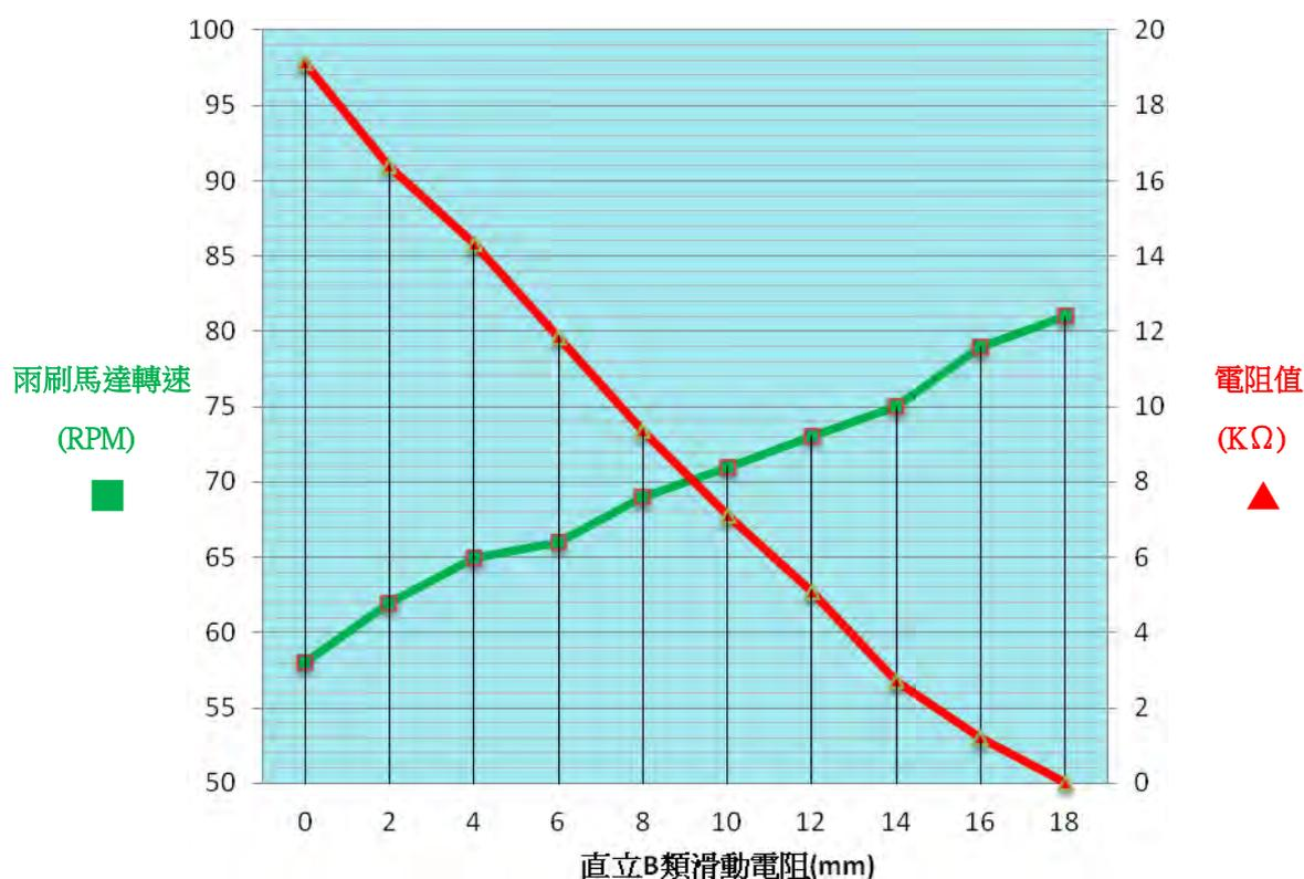
說明：當平均雨量大時，滑動電阻會因為儲水箱內的水位上升而推動滑動電阻，此時電阻值(上圖紅線)上升，兩刷馬達轉速(上圖綠線)降低。
