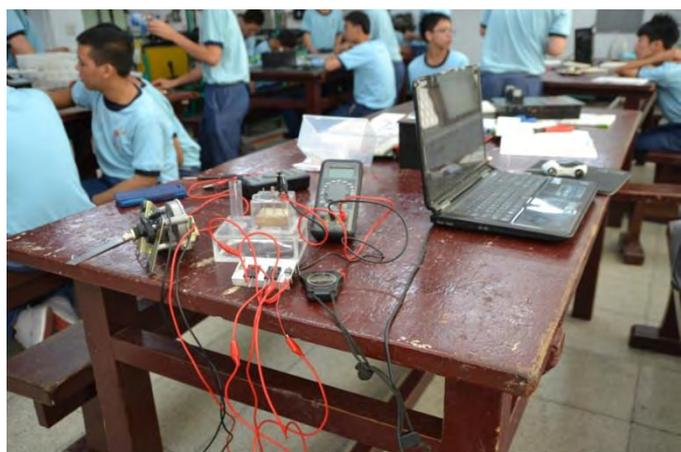
將成品接上兩刷及電瓶，使用三用電錶量測電流、電壓，使用碼錶記錄滑動電阻上升時馬達轉速的改變，並使用筆記型電腦記錄數據。
