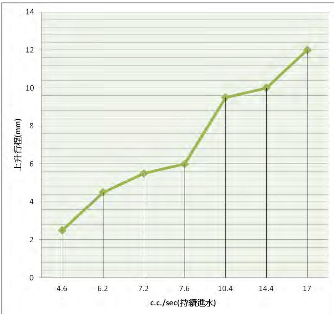
說明：當雨水進到儲水箱時，達到每秒鐘 4.6 c.c.時，滑動電阻上升行程會持續固定在 2.5mm 位置。水量固定在每秒 17 c.c.時，滑動電阻會固定 12mm 位置。由此圖可知，瞬時平均雨量能馬上改變滑動電阻的位置高度。
