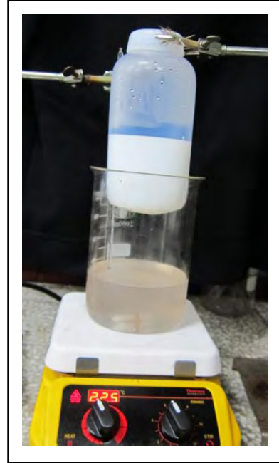
TiO 2 奈米管水熱法裝置
