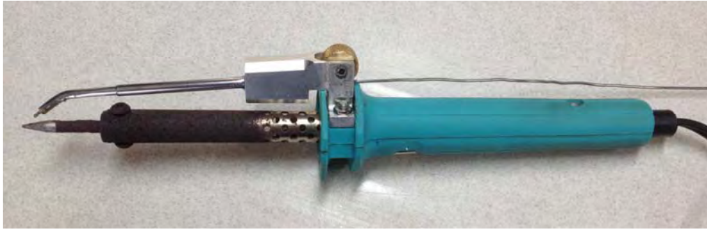
圖七 焊接輔助進錫裝置作品
