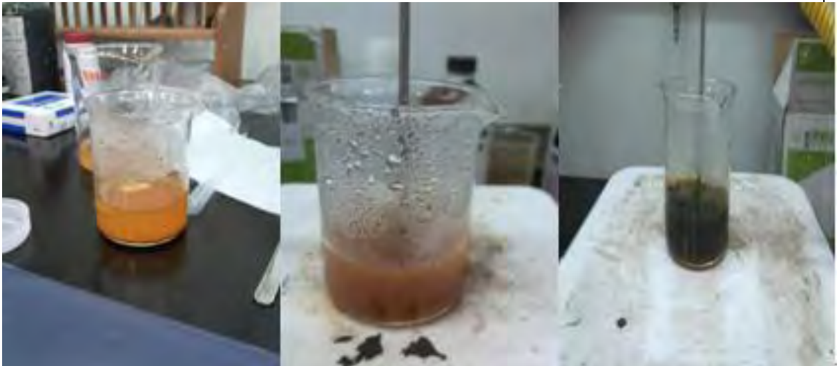
圖三 A 利用奈米氧化鐵顆粒溶液顏色可判斷顆粒大小變化 由於粒子越細，透光度就會越低(光進去會繞射)，所以顏色越深，其粒子顆粒越小
