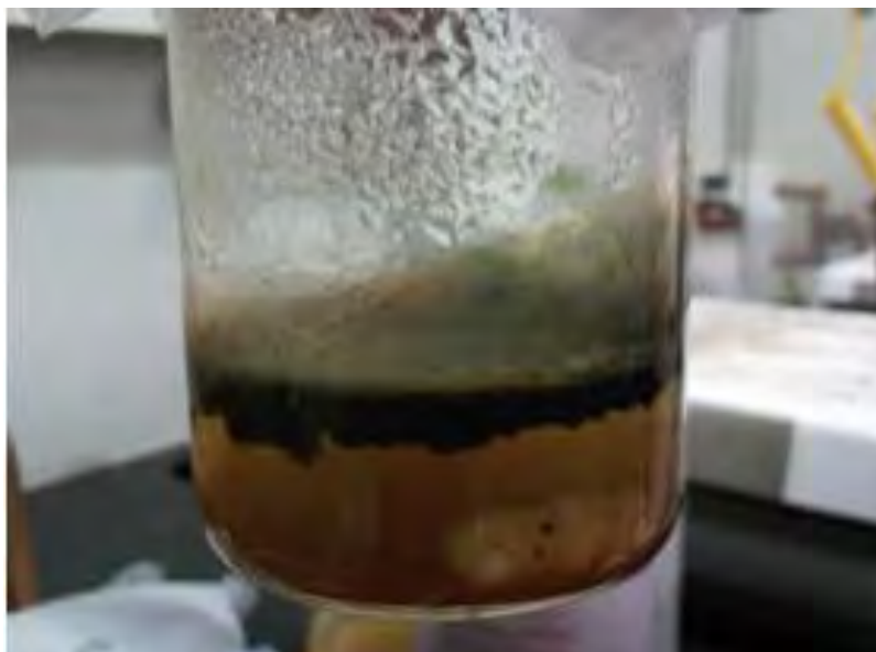
圖七 界面活性劑批覆粒子 上層：已批覆界面活性劑之奈米微粒子溶液 (且此奈米立子溶液可維持懸浮很久)
