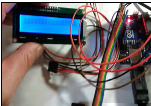
圖 4-13 LCM 模組測試
