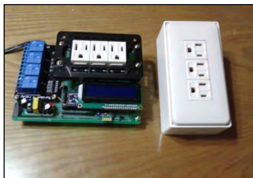
圖 5-17 原型機與開發完成產品比較
