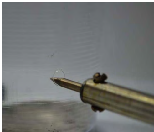
圖二十 以電烙鐵溶出洞孔
