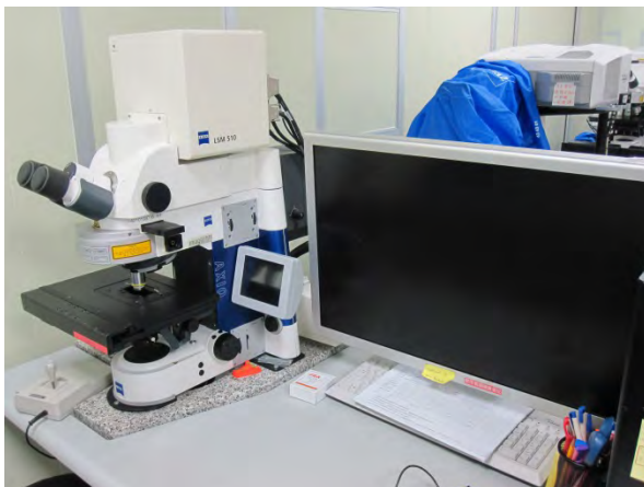
圖七 共軛焦螢光顯微鏡
