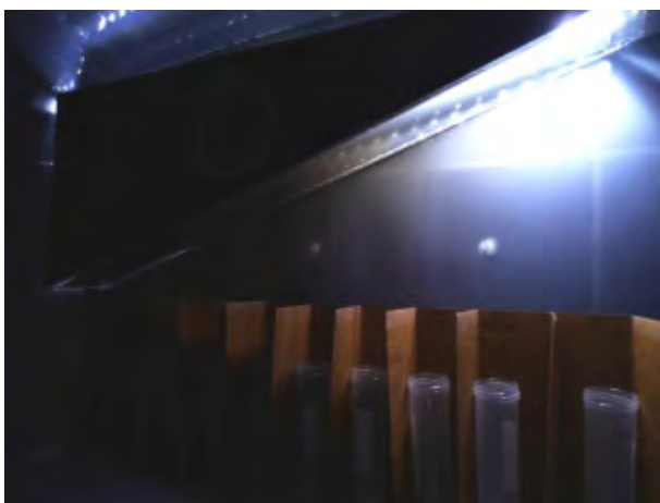
圖十 放入 10 根 50cc 的離心管並排列於 LED 燈受光面使其接受不同光照
