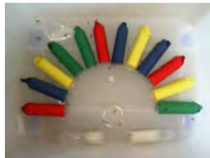
圖七 將離心管排在圓周上並以開口朝向圓心，以確保所有實驗巢穴與食物等距
