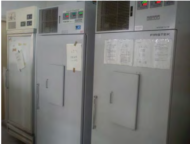
圖四、控溫生長箱 (YIH DER LE-509RD)
