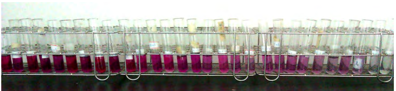
圖十六：打入 \text{NO}_2 氣體，並逐次增加 0.01ml，由 0.01ml 至 0.30 ml \text{NO}_{2(g)}
