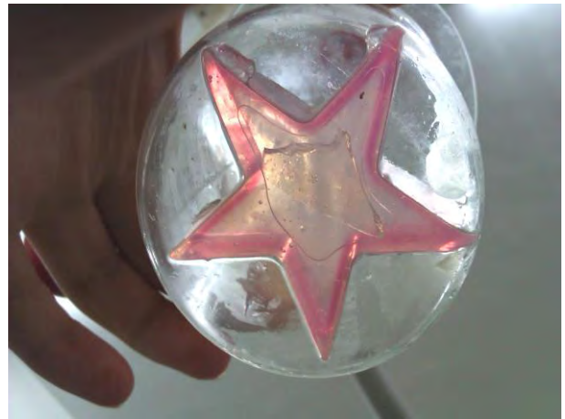
圖四：Griess reagent 貼片接觸 NO 2 氣體
