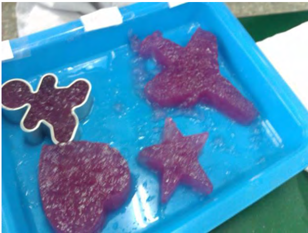
圖三：各式的 Griess reagent 貼片
