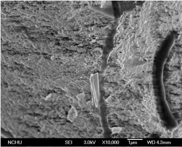
圖（二十三）泡水且放置 40 天的花崗岩剝裂試片
