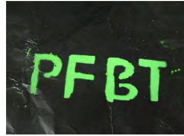
(圖 7) PMMA/PFBT 纖維在日光燈下情形 (圖 8) PMMA/PFBT 纖維在 UV 下情形
