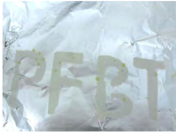
(圖 7) PMMA/PFBT 纖維在日光燈下情形 (圖 8) PMMA/PFBT 纖維在 UV 下情形
