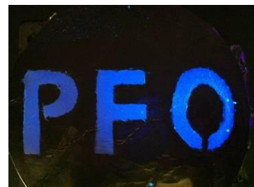
(圖 5) PMMA/PFO 纖維在日光燈下情形 (圖 6) PMMA/PFO 纖維在 UV 下情形
