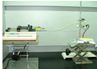
(圖 1) 電紡原理示意圖 (圖 2) 電紡實驗器材架設圖 (圖 3) 轉接頭與鐵氟龍管線
