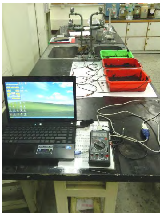
圖 5-20 三個淺盆電池與 LED 燈泡串聯裝置圖
