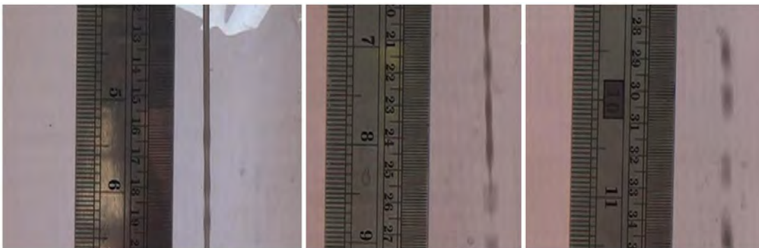
圖 7.1、7.2、7.3 為三個不同高度(由上而下)所拍攝之 7.80 mm 的水柱
