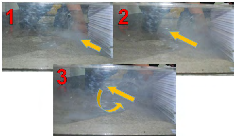
圖(十七) 新月形沙丘氣流流動情形示意圖。
