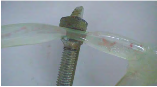
1. 模擬75%血管狹窄模型 :並與正常血管的管內液體流速與剪應力分佈作對照。
