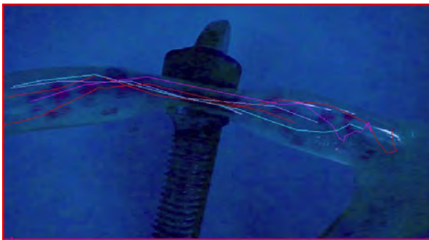
3. 利用tracker質點追蹤軟體，每1/30秒的時間間隔，點出質點的運動位置。(影片的攝影速率爲30張/秒)
