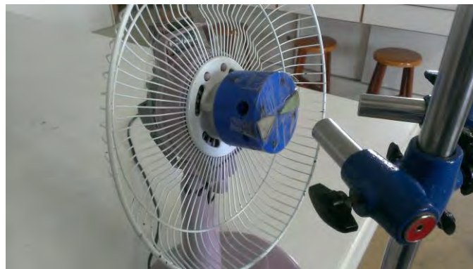
圖 4-7 利用鏡面反射發射極來測量轉速
