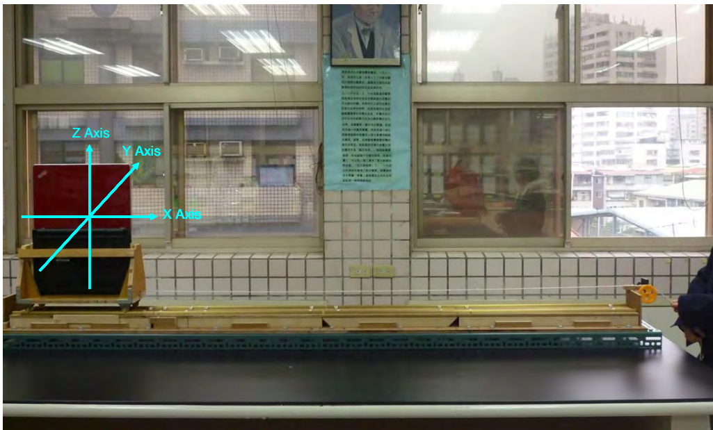
圖二、以繩索拉動台車，記錄加速度感測器在落下時的加速度值
