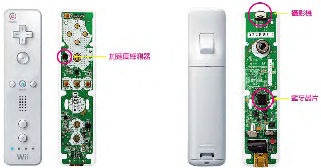
圖 1 Wii 遙控器的內部構造[7]
