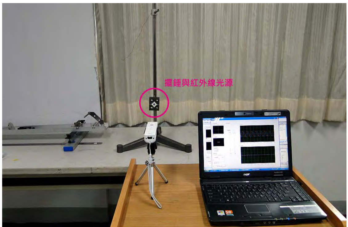
圖 12-1 單擺運動觀測裝置
