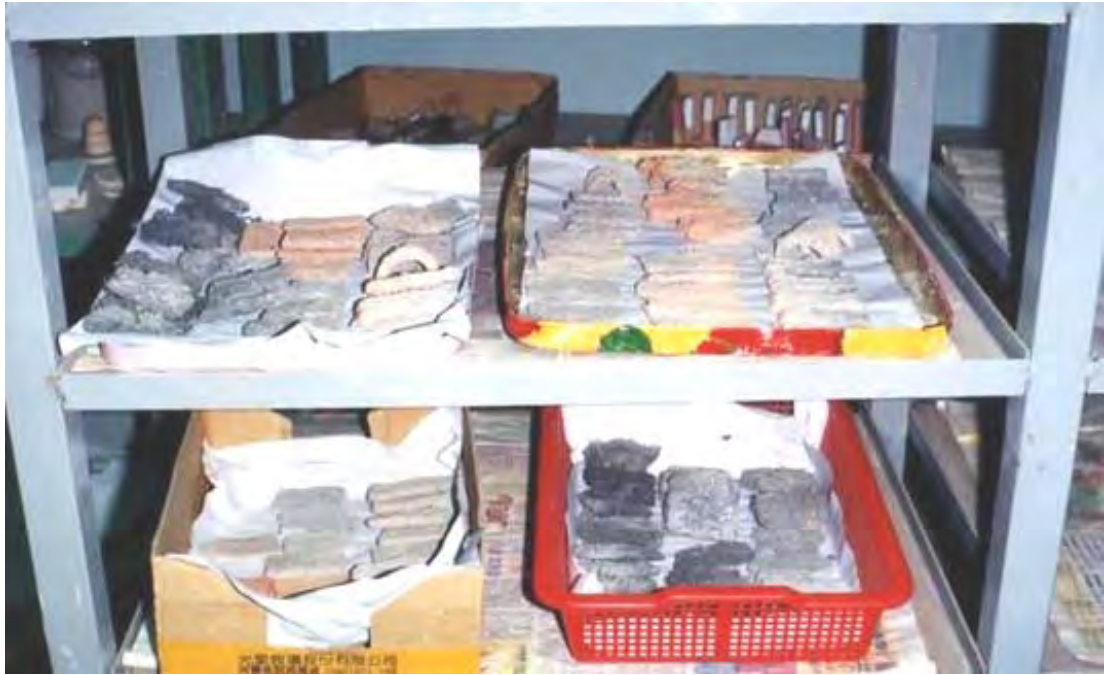
分組電燒 500 °C. 750 °C. 1000 °C. 1250 °C 的所有試片
