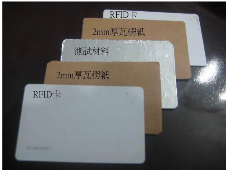
圖 4-3 RFID 屏蔽測試之元件堆疊方法
