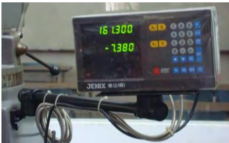
圖 3-3 光學尺（精度 0.01mm）
