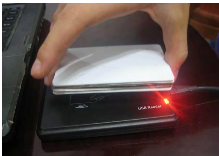
圖 4-4 RFID 屏蔽測試之元件堆疊
