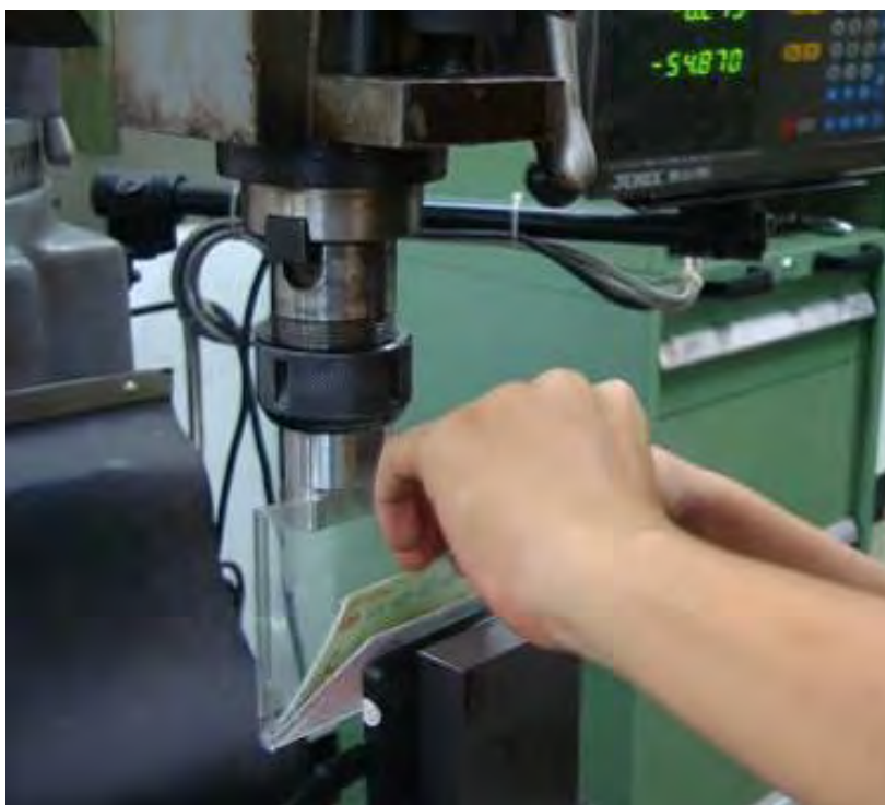
圖 4-2 將 RFID 卡、間隔紙和屏蔽材料放置於透明壓克力盒
