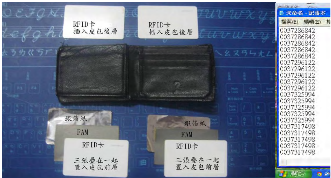
圖6-6 放四張RFID卡之皮夾設計
