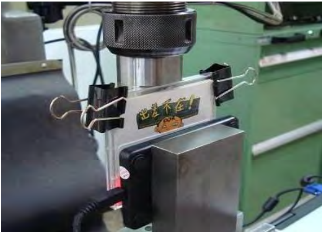
圖 3-6 RFID 讀取裝置安裝於銑床上
