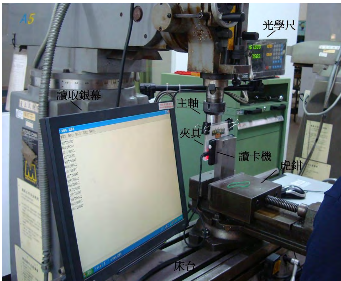
圖 3-4 銑床上之 RFID 讀取設置
