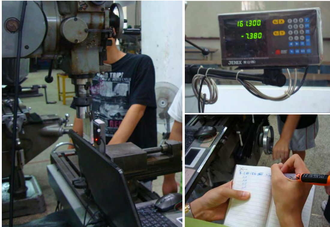
圖 4-6 RFID 讀取距離測試 (床台移動、光學尺讀數、紀錄讀取距離)
