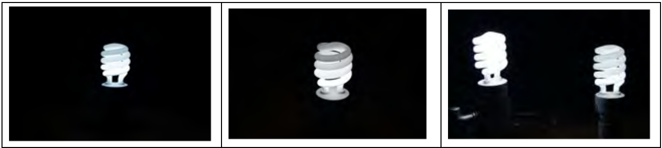
圖 4-1-3 螺旋燈管的光衰現象
