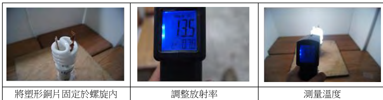
圖 4-3-1 設有導熱銅片燈管散熱的實驗
