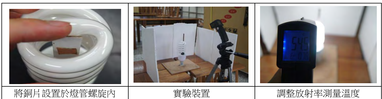
圖 4-4-1 未使用小型風扇時螺旋內部散熱的實驗
