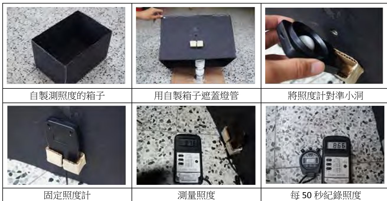
圖 4-1-2 測量照度的實驗
