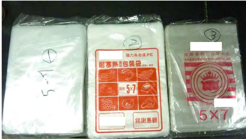
圖一 市售塑膠袋，材質為低密度聚乙烯（左）、高密度聚乙烯（中）、聚丙烯（右）
