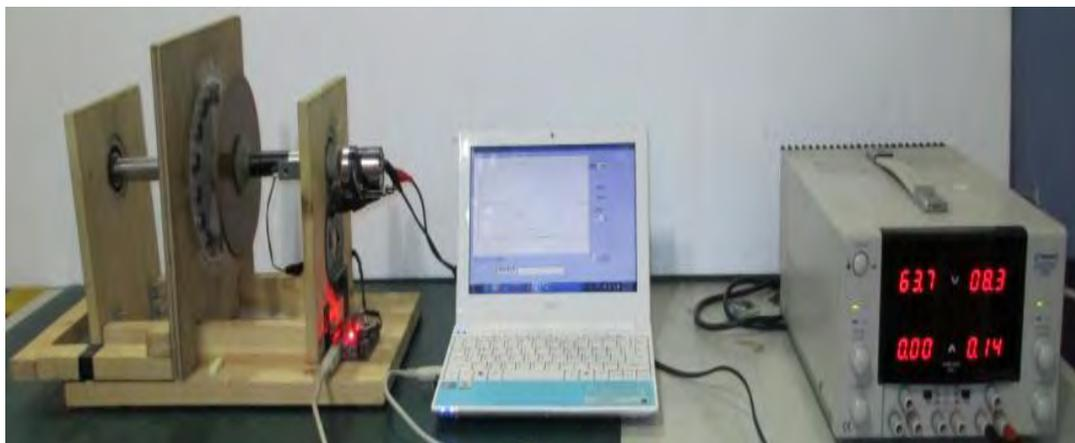
圖 4-2-3 渦電流煞車分析系統
