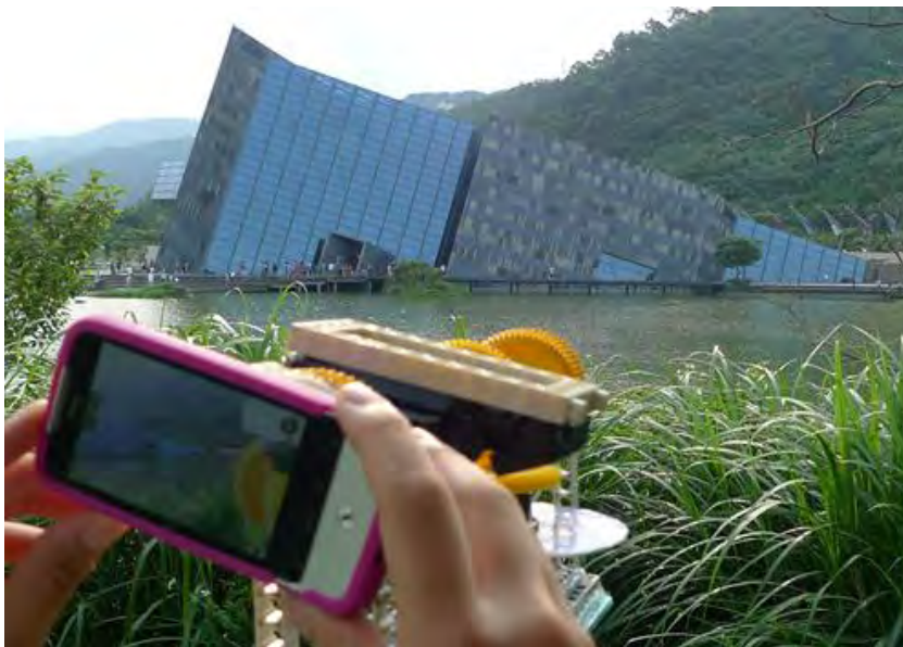
圖十一：實際測量蘭陽博物館主體建築的傾角
