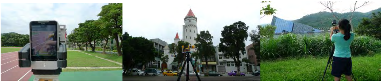
圖二十：利用水平角度測量平台來測量三度空間中的水平夾角
