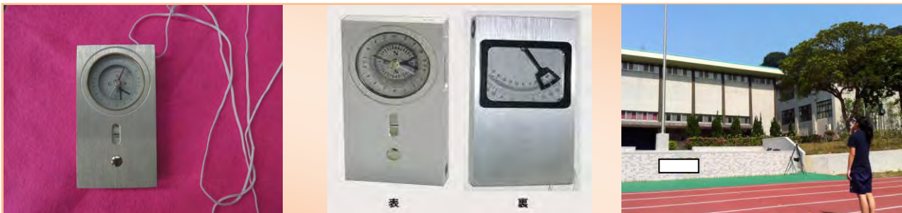
圖十四：傾斜儀及其測量的方式
