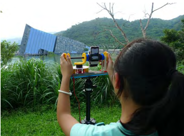
圖十八：測量蘭陽博物館主體建築最高處的仰角
