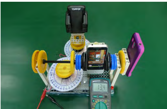
圖八：第四代三維角度可變電阻量角器 核心結構：三合一快拆測量平台 優點：可測水平、垂直、傾斜角度
