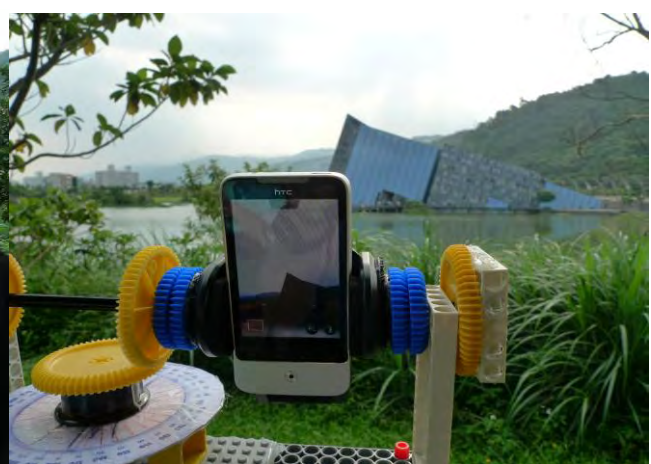
圖十八：測量蘭陽博物館主體建築最高處的仰角
