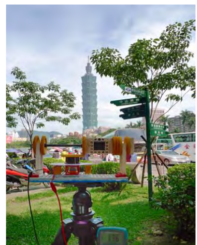
圖十七：測量台北 101 大樓 509.2 米高之最高點頂端及 439.2 米高之屋頂平台的仰角 左：距離 400m 中：距離 700m 右：距離 980m
