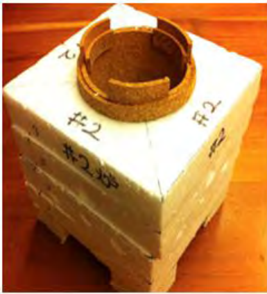
照片 1(a).小型燃燒爐實體照片
