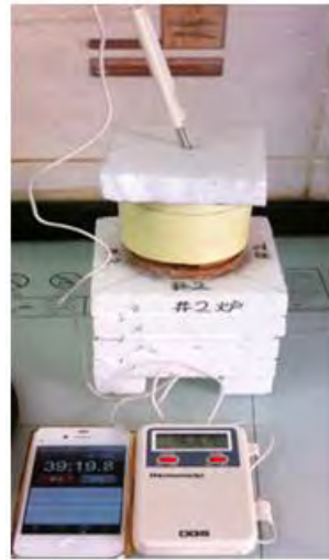
照片 1(b).小型燃燒爐-水杯系統及計時器與測溫器
