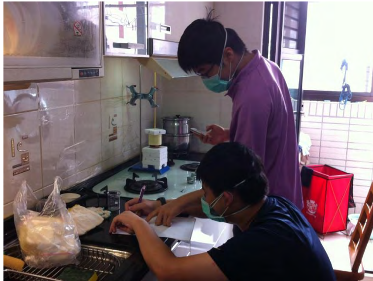
圖二說明： 落葉碳質燃料於自製燃燒爐中燃燒，學生測量其釋放的熱量並紀錄下來。
