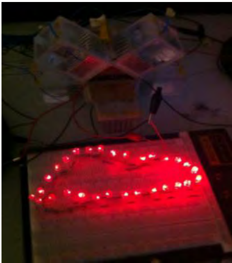
照片 6(a).電三代小屋輸出 1.3v，點亮台 灣地圖造型的 LED 燈組模型
