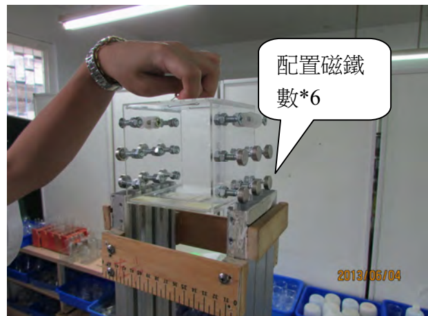
左右各配置6個磁鐵
