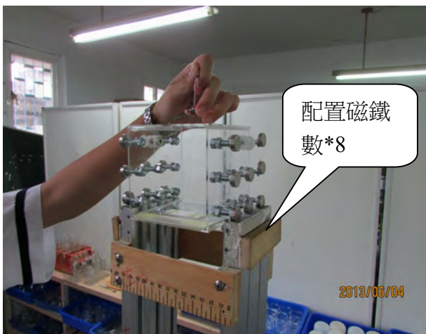
左右各配置8個磁鐵
