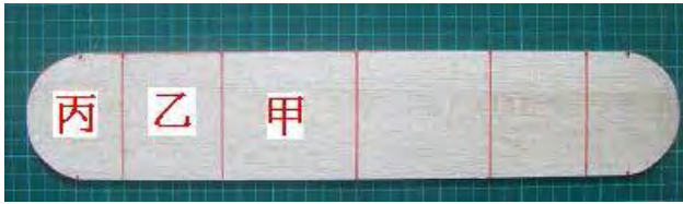
圖 4-10-1 主翼上反角切割的比例
