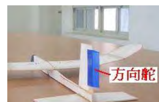
圖 4-14-3 垂直尾翼加裝方向舵
