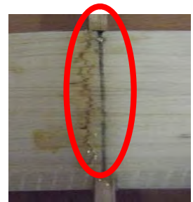
圖 4-2-6 主翼易斷裂處
