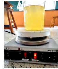
用加熱攪拌器攪拌添加戊二醛的幾丁聚醮溶液
