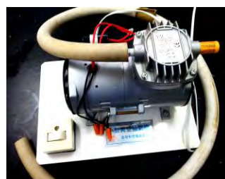
抽氣過濾設備 圖 7
