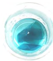
40°C, 0.125M, GA0 銅離子吸附明顯增加，溶液顏色明顯較淡
