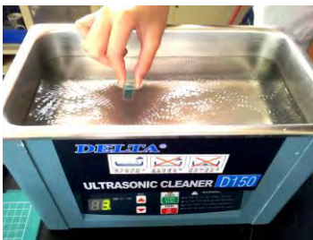
將裝有溶液之石英管放入震盪機以去除氣泡
