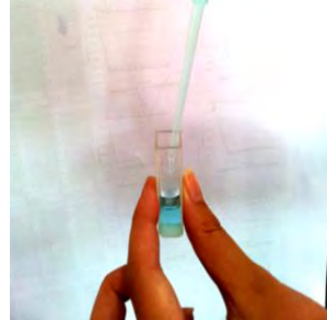
將硫酸銅溶液加入石英管(tube)
