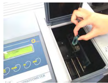
以紫外線光譜儀測量溶液的吸光度(abs)
