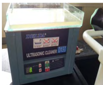
超音波震盪機去除溶液表面的氣泡
