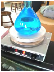
以加熱攪拌器使硫酸銅溶液完全溶解
