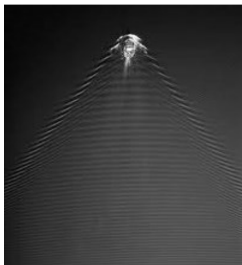
圖 1-1 船後兩條水痕線的夾角稱為水波夾角（ 2\theta ）
