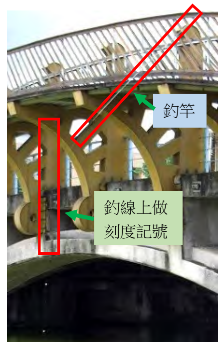
圖 4-11 用釣竿鉛錘法測量東湖景觀橋下實際水深
