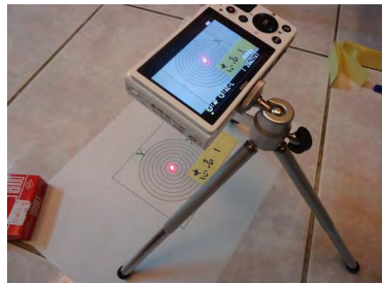
圖 50 以 P310 相機錄影雷射光點
