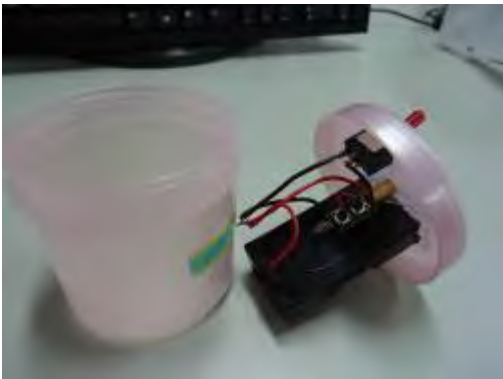
圖 17 初步製作的雷射筆固定盒
