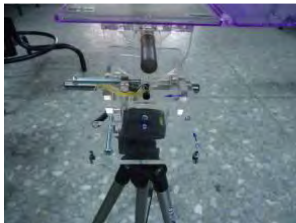
圖 25 萬向反射鏡安裝於相機腳架上
