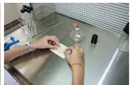
6.以壓板使樣品液凝膠成形
