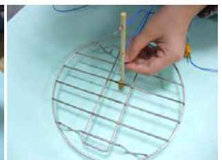
(4)熱電耦線固定於蒸架上
