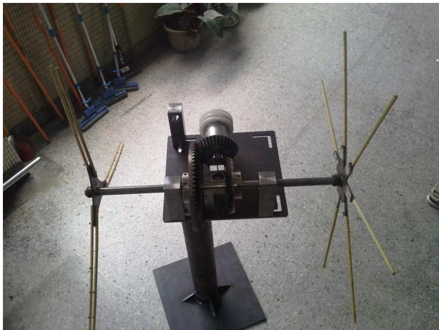
圖 17 垂直軸發電模式實際組裝成果圖(適合瀑布、河流、風力)
