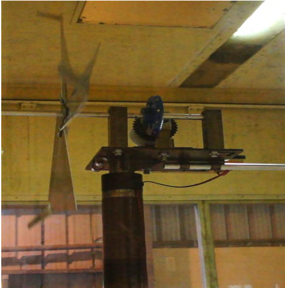
圖 22 CG 模式配合高速葉片於大型風洞實驗
