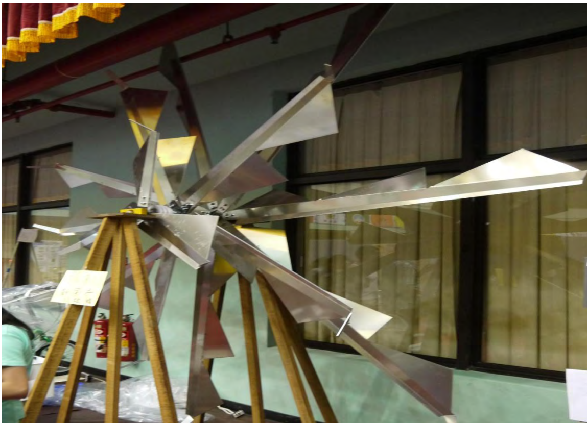
圖 2-2 水平軸三層風動能擷取 SG 初級應用完成實體
