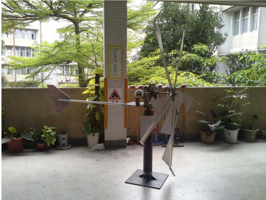
圖 16 水平軸發電模式實際組裝成果圖(適用風力、河流、洋流)
